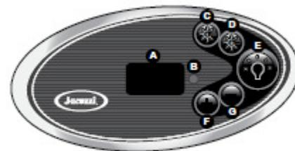
**C : BOMBA 1**
