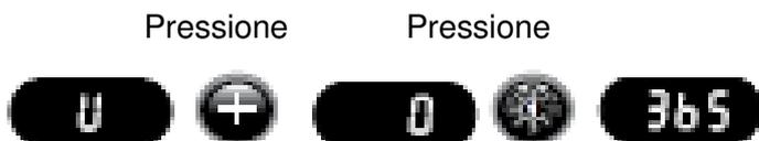
1. Pressione e mantenha pressionado o botão Bomba 1 ( ) e o botão Diminuir Temperatura da Água ( ) simultaneamente por 3 segundos.
